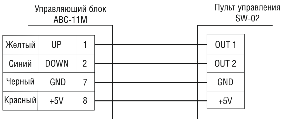
Рисунок 6.8.2 Схема подключения пульта дистанционного управления шлагбаумом «SW-02»
