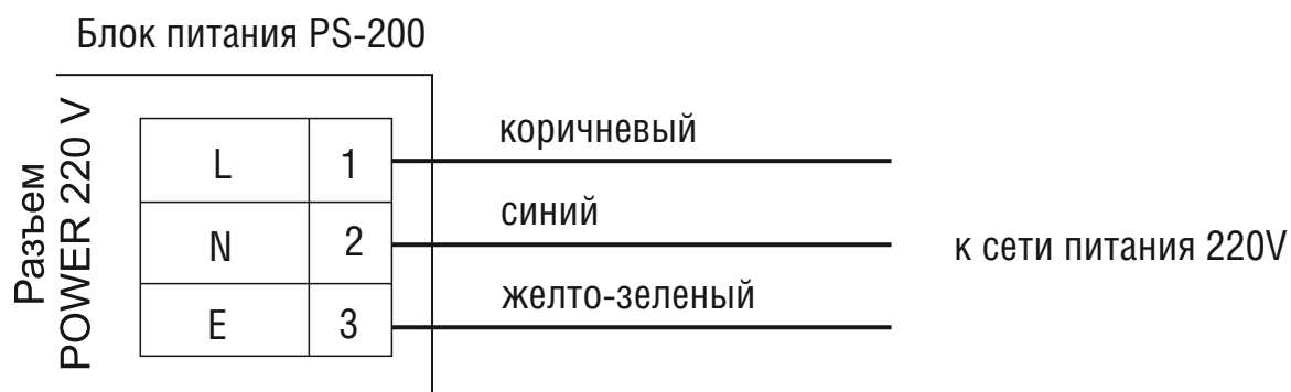
Рисунок 7.5.1 Схема подключения блока питания
