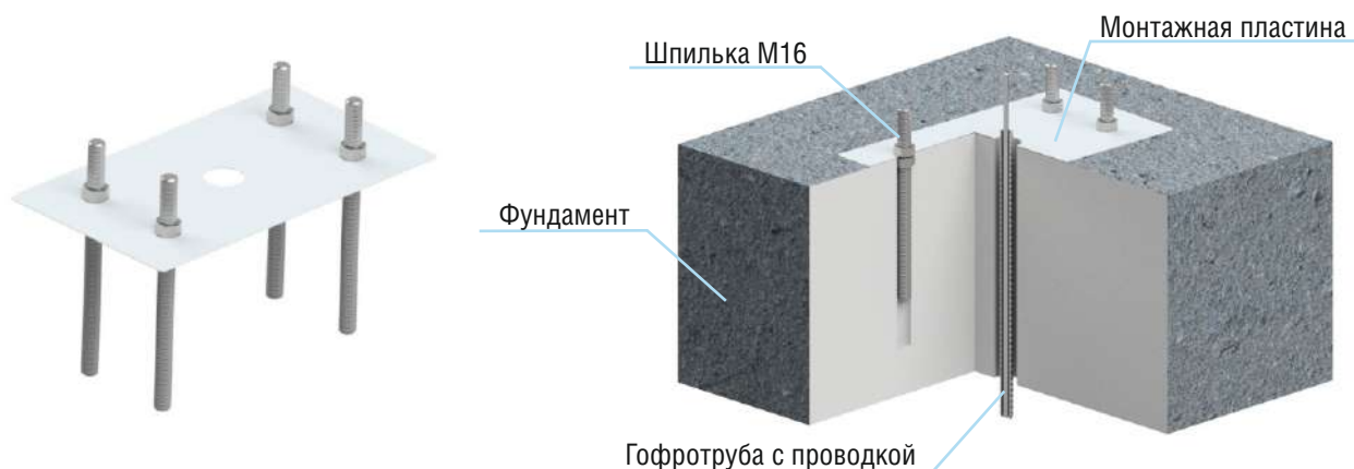
Рисунок 7.2.1 Устройство фундамента с монтажным комплектом
